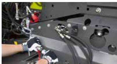
Lösen der Hydraulikkupplung.
