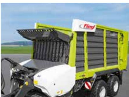
Hydraulisch nach vorne schwenkbare Befüllklappe
