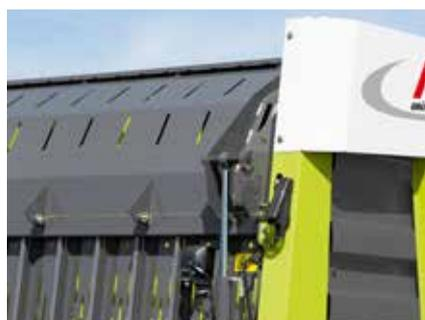
Winkelsensoren an der Befüllklappe.
