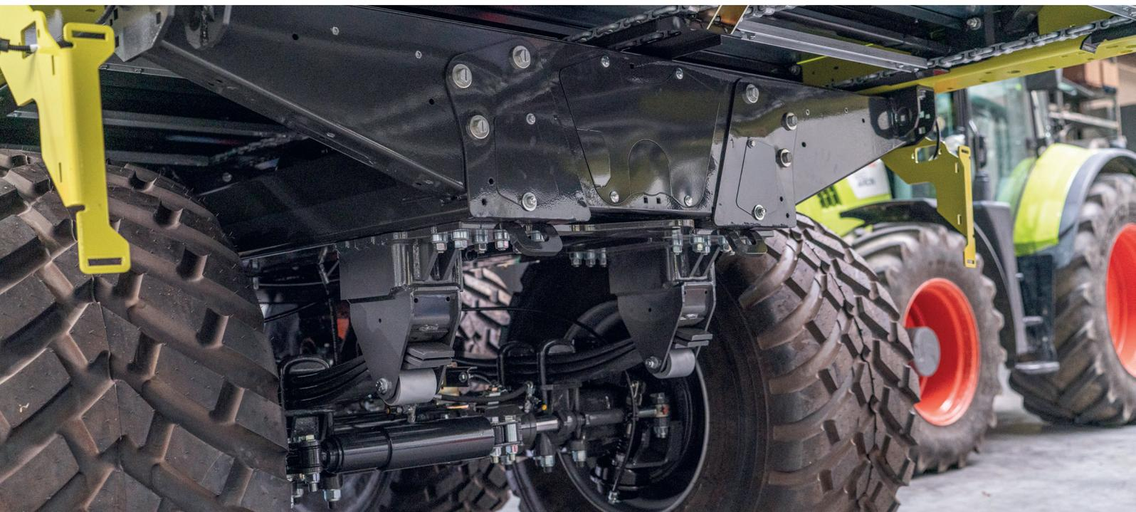
Les profilés longitudinaux sont « ouverts » vers l'extérieur pour une pose propre et une accessibilité optimale.
