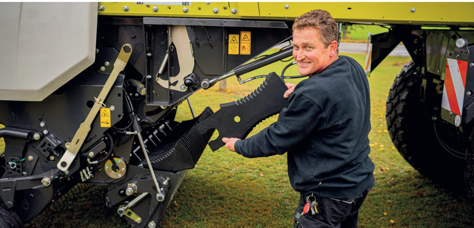
Tous les couteaux sont déverrouillés à l'aide de la clé fixée sur le chariot. Il est ainsi facile de changer ou de faire tourner les couteaux. Si un couteau est coincé, la clé permet de le retirer. La clé permet également de débloquer facilement les différents couteaux.
