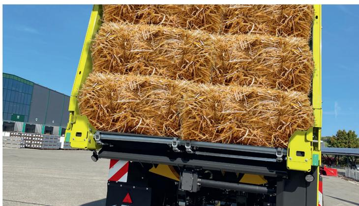
Grâce à la marche arrière du fond mouvant, le transport des balles est également possible. Le transport des balles est possible et ce, sans sécurité de transport supplémentaire.
