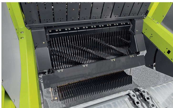
Accès libre au rotor, au bac de coupe, à la barre de coupe et aux couteaux. Des points positifs pour un nettoyage rapide et efficace de la machine.
