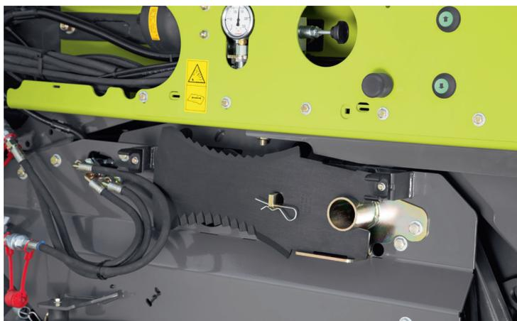
Les supports de stationnement permettent d'emporter un jeu supplémentaire de lames doubles. Ainsi, des lames affûtées de manière optimale sur quatre côtés garantissent une qualité de coupe maximale sur des périodes d'utilisation.
