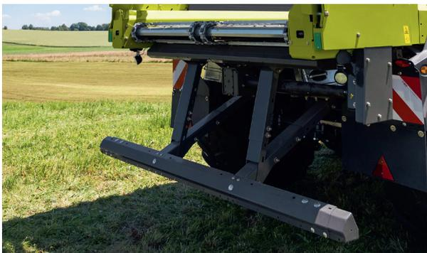
En option avec protection anti-encastrement sur les CARGOS 700, 8000 et 9000. Sur la CARGOS 800, la protection anti-encastrement est obligatoire.
