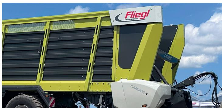
Ridelle avant pivotante Pro, à pivotement hydraulique - pour un volume de chargement encore plus important et un déchargement plus rapide.
