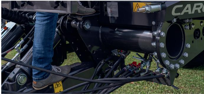
Réduction du nombre de distributeurs du tracteur nécessaires grâce à la commande séquentielle du fond mouvant (en option)
