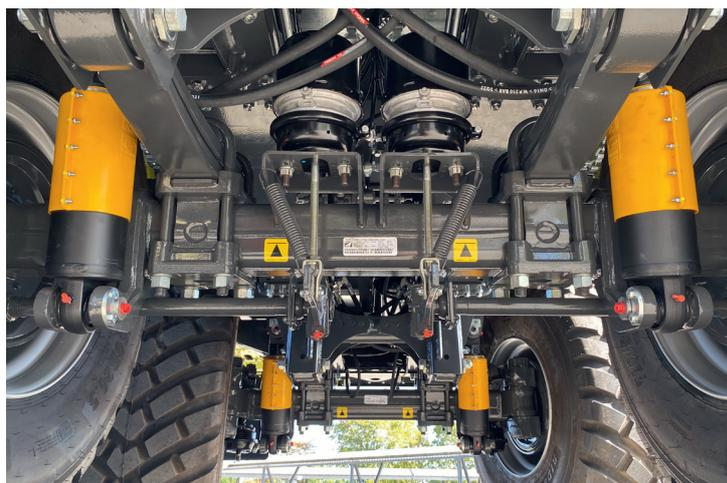
Version hydraulique suspension à ressort.
