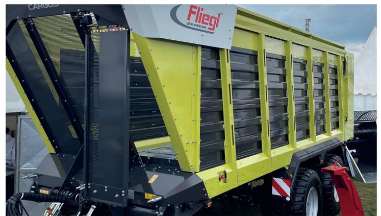
La CARGOS se caractérise par un distance entre les rangers très étroit. La trappe d'accès du le wagon de transport se trouve délibérément dans la paroi frontale. Ainsi, la répartition optimale des forces sur les côtés n'est pas interrompue. La porte latérale n'interrompt pas la répartition des forces sur les parois.
