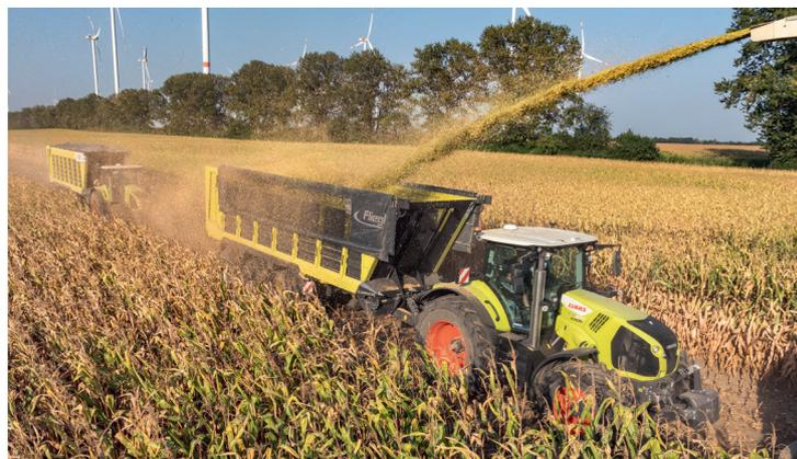
Transport d'ensilage, que ce soit avec le wagon de transport ou avec la remorque autochargeuse combinée.
