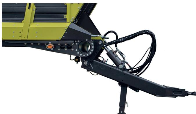
Barre d'attelage CARGOS 700, charge d'appui 3 ou 4 tonnes
