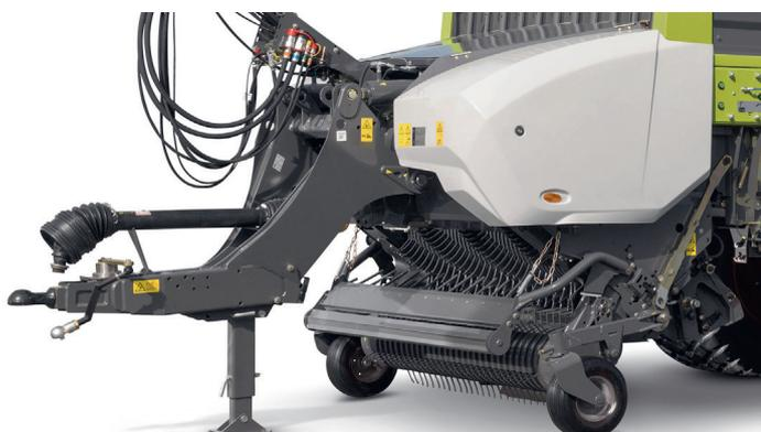
Barre d'attelage CARGOS 8000/9000, charge d'appui 3 ou 4 tonnes
