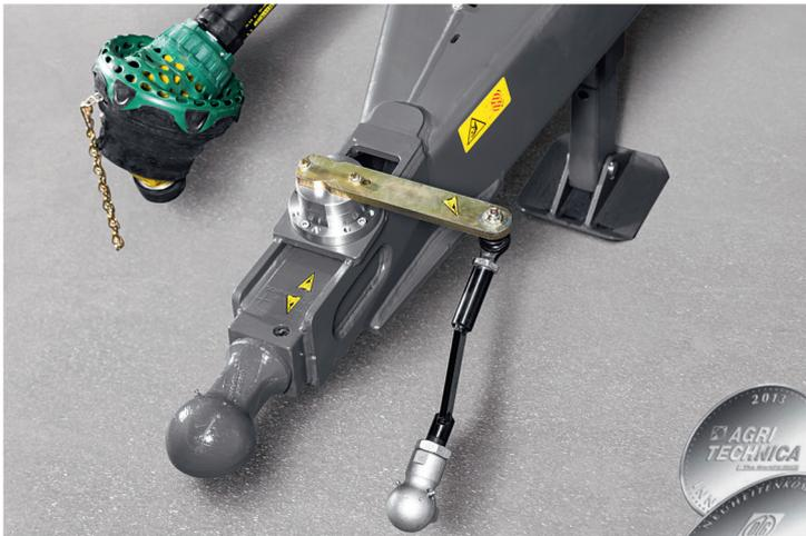
Illustration de la direction forcée électrohydraulique.
