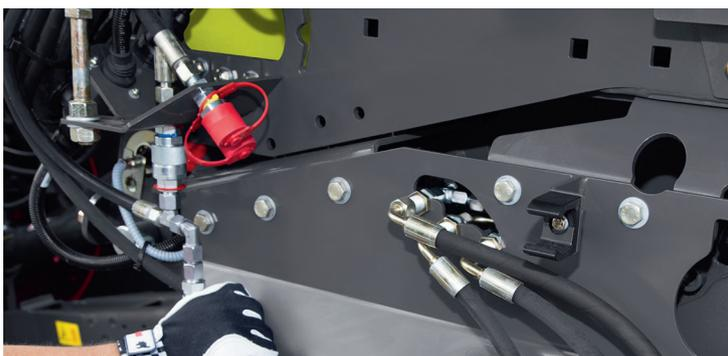
1. Déconnexion des 5 conduites hydrauliques et d'un connecteur électrique
