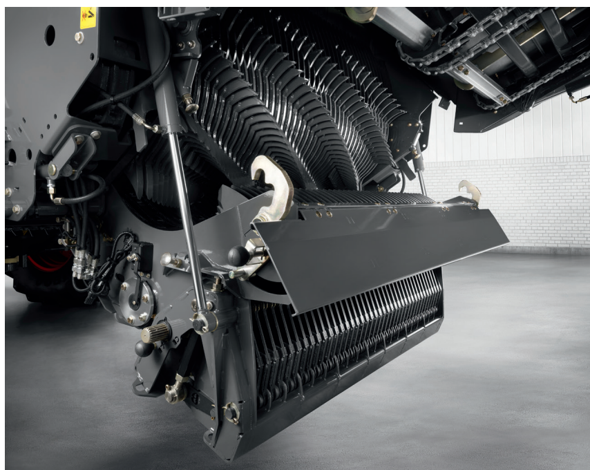
Freier Zugang zum Rotor in der Reinigungsposition
