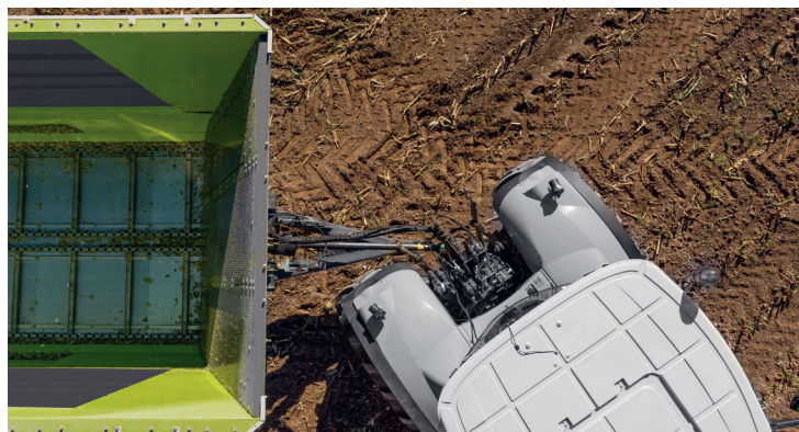
Extrem schlanke Ausführung für maximalen Lenkeinschlag
