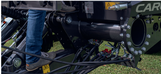
CARGOS 700: Reduzierung der benötigten Steuergeräte durch Kratzbodenfolgeschaltung
