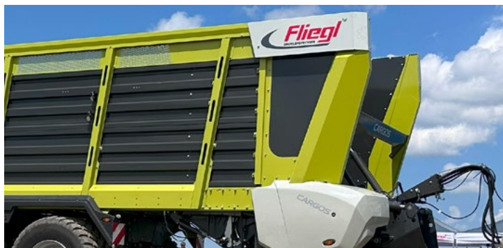
Svängbar frontvägg Pro, hydrauliskt svängbar - för ännu större lastvolym och snabbare avlastning.
