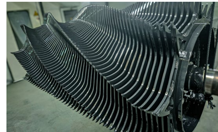
Nio rader av rotortänder som är fastsatta på rotormanteln och svetsade.
