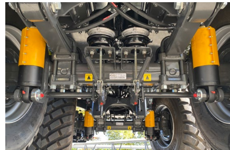
Hydrauliskt fjädrat chassi med automatisk utjämning av sluttningar.
