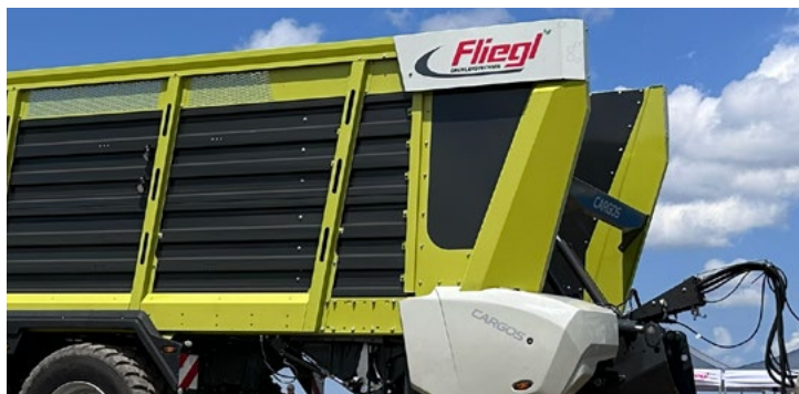
Zwenkbare voorwand Pro, hydraulisch zwenkbaar - voor nog meer laadvolume en sneller lossen.
