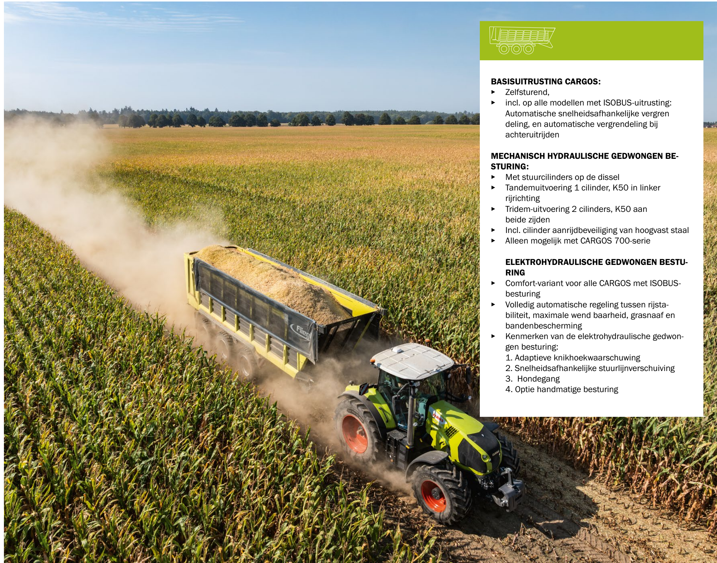
Mechanisch-hydraulisch gedwongen gestuurd tridem-voertuig
