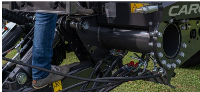
CARGOS 700: Minder besturingseenheden nodig dan bij sequentiële besturing van de bodemketting
