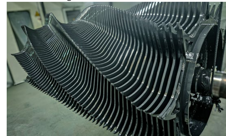
Negen rijen rotortanden gemonteerd en gelast op het rotorhuis
