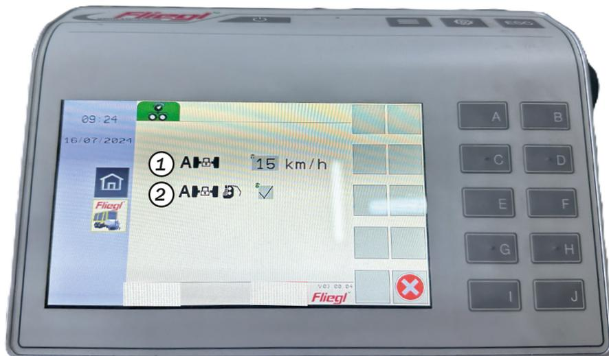
1. Le blocage automatique de l'essieu directeur bloque automatiquement l'essieu directeur à la vitesse réglée (par exemple : 15 km/h). La fonction est inactive à la vitesse de 0 km/h.
