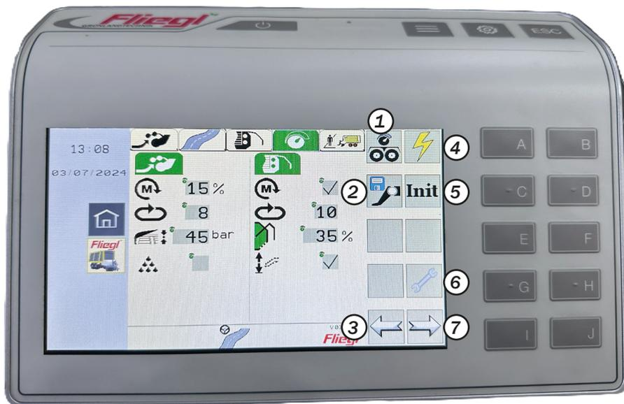
1. Ouvrir les paramètres du châssis
