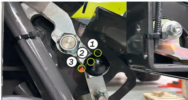
L'auge de coupe doit être verrouillée en position d'inviolabilité (2) pendant le chargement !
