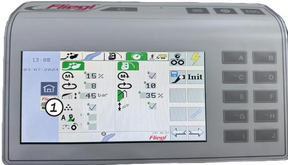
L'alimentation en additifs d'ensilage comprend une ligne de commande qui permet de contrôler un système d'additifs d'ensilage pendant le chargement. Dès que l'entraînement du pick-up est en marche et que l'alimentation en additif d'ensilage (1) est activée, la broche 2 du connecteur XZ est activée.
