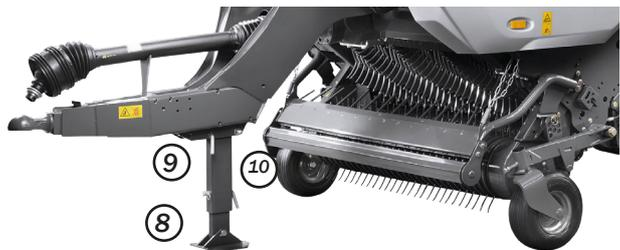
La jambe de support (8) doit être fixée à l'aide de boulons (10) et de goupilles (9) lors du montage et du démontage de la machine
