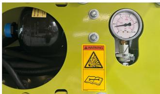
Les accumulateurs sont pressurisés avec du gaz et de l'huile. Ne les démontez et ne les réparez qu'en suivant les instructions du manuel technique.
