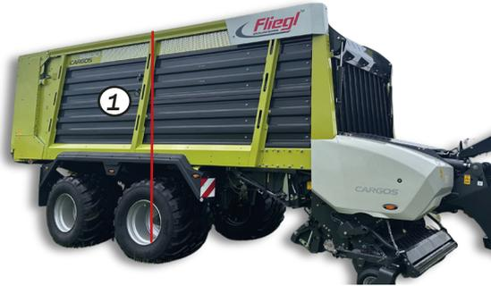
Après avoir réglé ou modifié la hauteur du châssis, mesurez toujours la hauteur totale du véhicule
