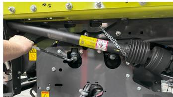
Desserrer les quatre vis Couple de serrage d'environ 420 Nm lors de l'installation de l'appareil.
