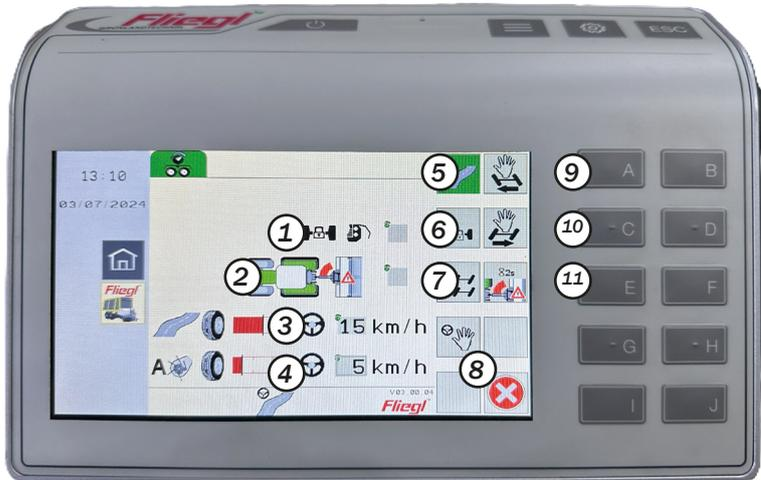
1. Automat. Verrouillage du ou des essieux en mode déchargement activé / désactivé
