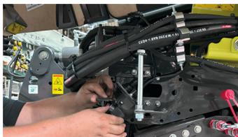
Séparation des connexions hydrauliques gauche et droite dans le sens de la marche et de la connexion électronique par le biais d'un raccord rapide.
