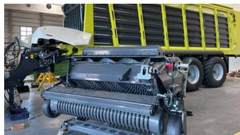
Relever la barre de traction. L'unité peut maintenant être retirée. Montez les supports et insérez les plaques de coupe (voir page 45).
