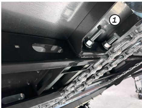
Le serrage de toutes les connexions boulonnées doit être vérifié après les premières heures d'utilisation, y compris les connexions boulonnées du plancher en acier et des rails du fond mouvant !
