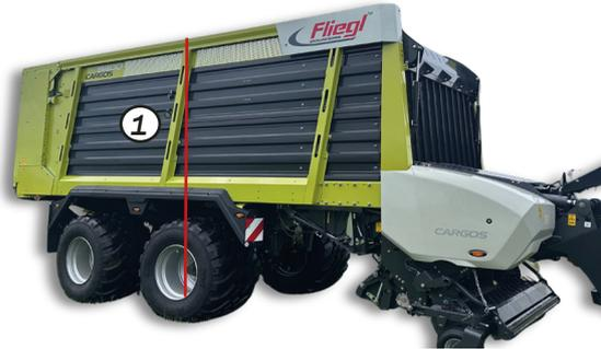
Nach jedem Einstellen bzw. Verändern der Fahrwerkhöhe unbedingt die Fahrzeug-Gesamthöhe mittig am Achsaggregat messen (links und rechts) und prüfen, ob der Wagen waagrecht steht (seitliche Neigung).
