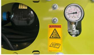
Druckspeicher stehen unter Gas und Öldruck. Ausbau und Reparatur nur nach Anweisung im technischen Handbuch.
