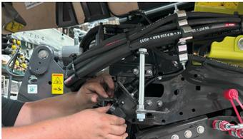
Trennung der Hydraulikanschlüsse in Fahrtrichtung links und rechts sowie der Elektronikverbindung über Schnellkuppler.
