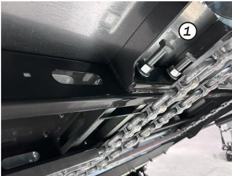
Alle Schraubverbindungen sollten nach den ersten Einsatzstunden auf festen Sitz überprüft werden, u. a. die Schraubverbindungen des Stahlbodens und der Kratzbodenleisten!
