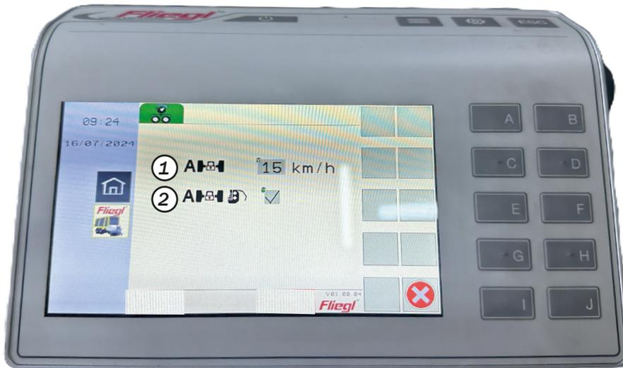
1. Die automatische Lenkachsverriegelung verriegelt die Lenkachse bei eingestellter Geschwindigkeit automatisch (z.B.: 15 km/h). Bei der Einstellung 0 km/h ist die Funktion inaktiv.
