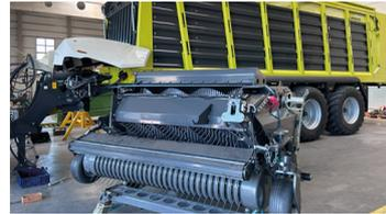
Knickdeichsel anheben. Das Aggregat kann nun entfernt werden. Montage der Halterungen und Einlegen der Häckselbleche. (s. Seite 45)
