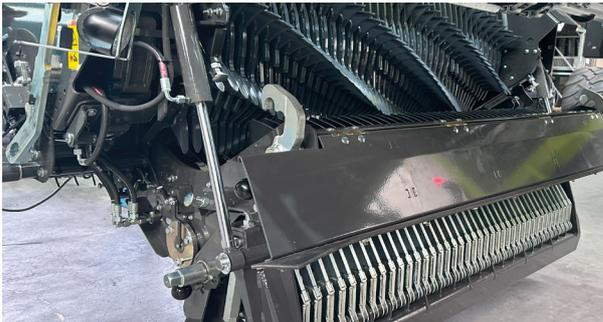
Die Schneidmulde muss beim Beladevorgang in „Stopferposition“ (2) verriegelt sein! Nur so wird die Schneidmulde im Falle eines Stopfers einige Zentimeter aufgeschwenkt werden und genügend Durchgang für Fremdkörper etc. zur Verfügung stellen.
