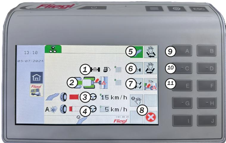
1. Automat. Sperren der Achse(n) im Entlademodus ein/aus
