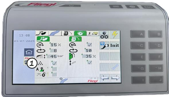
Die Siliermittelzufuhr besteht aus einer Steuerleitung, die es ermöglicht, während des Beladens einer Siliermittelanlage anzusteuern. Sobald der PickUp Antrieb läuft und die Siliermittelzufuhr (1) eingeschaltet ist, wird der Pin 2 der Steckverbindung XZ (2) bestromt. Pin 1 ist mit Leistungsmasse belegt. Die Leitung ist mit maximal 3A zu belasten.
