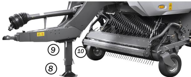
Der Stützfuß (8) ist per Bolzen (10) und Klappsplinte (9) beim An- und Abbau der Maschine zu sichern
