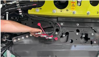
Demontage des Rotorantriebs. Die Bogenzahnkupplung kann bequem auf eine dafür vorgesehene Halterung abgelegt werden.
