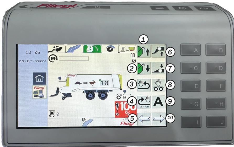
1. Heckklappe öffnen
