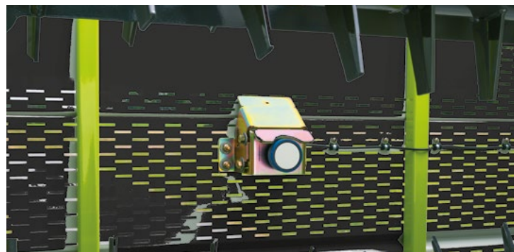
Capteur de niveau sur le hayon
