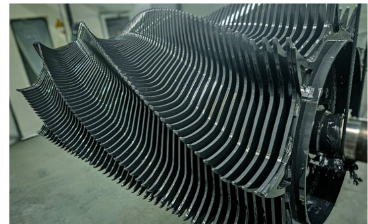
Neuf rangées de dents enfichées et fixées sur le manteau du rotor. dents de rotor vissées
