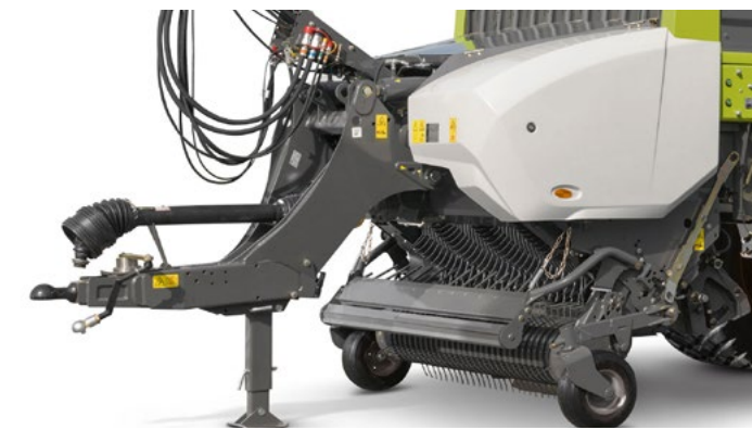
Barre d'attelage CARGOS 8000/9000, charge d'appui 3 ou 4 tonnes
