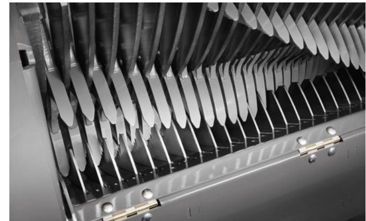
Ailerons d'alimentation de 22 mm de large pour un respect optimal de la nourriture
