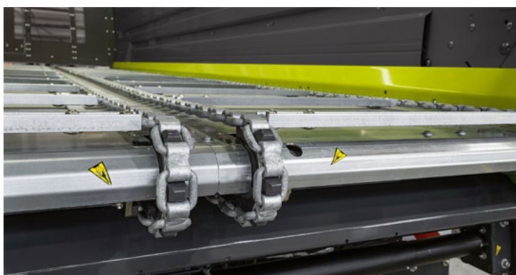
Chaînes de fond mouvant galvanisées, résistantes à la charge et à la déchirure
