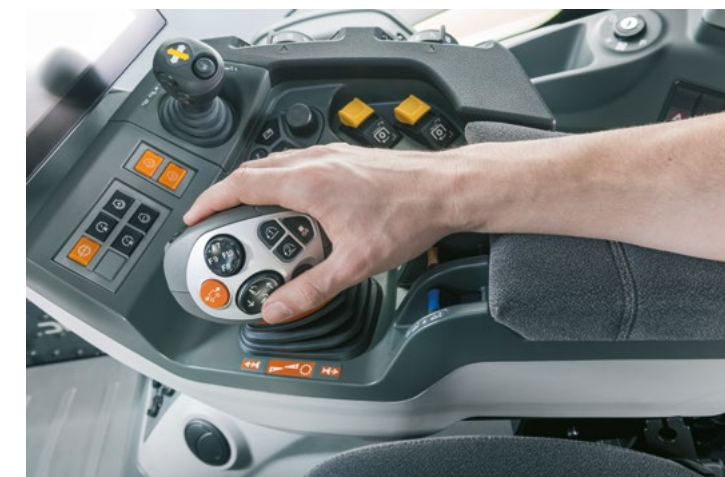
Programmation des fonctions ISOBUS sur le JoyStick
