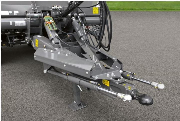
Illustration mécanique direction forcée hydraulique Véhicule tridem
