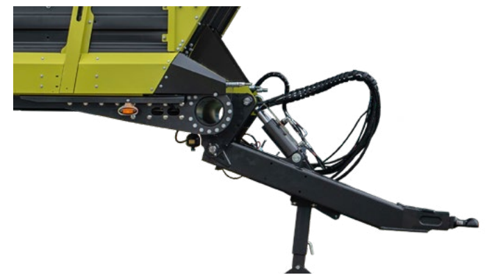
Barre d'attelage CARGOS 700, charge d'appui 3 ou 4 tonnes
