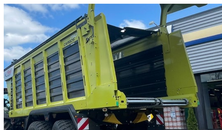
Le couvercle arrière a une hauteur de chargement énorme, qui permet même de charger 3 balles de foin ou de paille empilées par 90. L'angle d'ouverture est réglable. De plus, il se règle avec précision.
