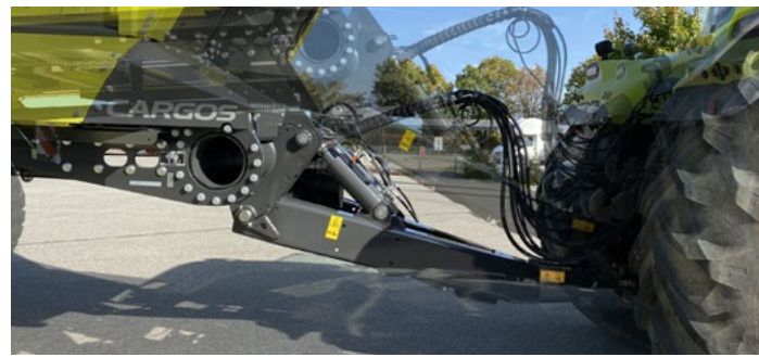
Timon articulé à la manière d'un essieu relevable Sytem-braquage
