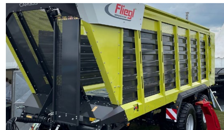
La CARGOS se caractérise par une distance entre les rangers très étroite. La trappe d'accès du wagon de transport se trouve délibérément dans la paroi frontale. Ainsi, la répartition optimale des forces sur les côtés n'est pas interrompue. La porte latérale n'interrompt pas la répartition des forces sur les parois.
