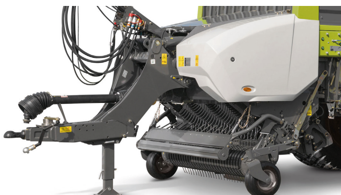
Barre d'attelage CARGOS 8000/9000, charge d'appui 3 ou 4 tonnes
