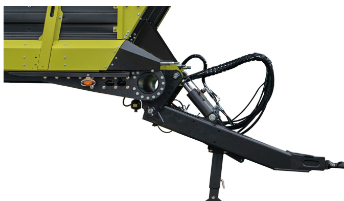
Barre d'attelage CARGOS 700, charge d'appui 3 ou 4 tonnes
