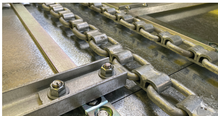
Barres de guidage galvanisées, barres de fond mouvant galvanisées et vissées
