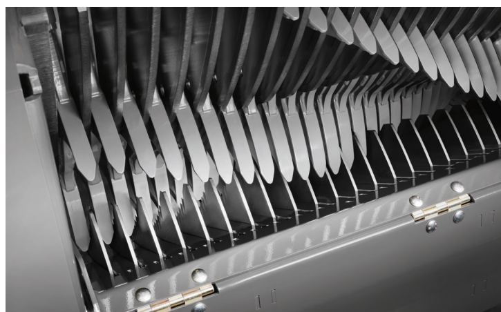
Ailerons d'alimentation de 22 mm de large pour un respect optimal de la nourriture
