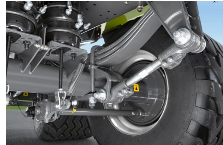
Mechanische Parabelfederung, serienmäßig mit Federbegrenzungsbuchsen für maximale Standsicherheit.
