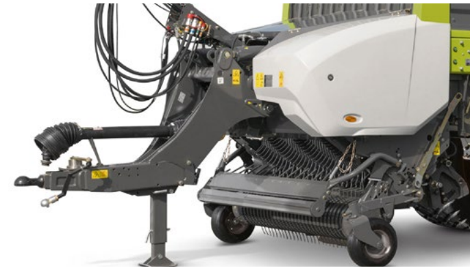
Zugdeichsel CARGOS 8000/9000, Stützlast 3 bzw. 4 To
