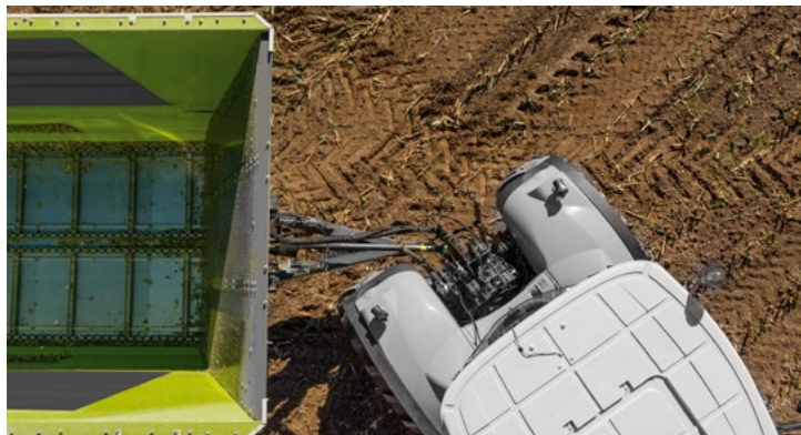
Extrem schlanke Ausführung für maximalen Lenkeinschlag
