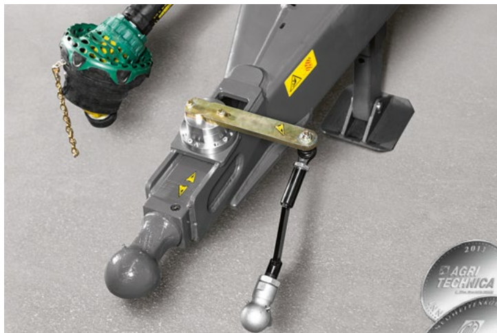
Elektro-Hydraulische Zwangslenkung, K50 in Fahrtrichtung links am Traktor notwendig
