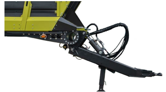
Zugdeichsel CARGOS 700, Stützlast 3 bzw. 4 To
