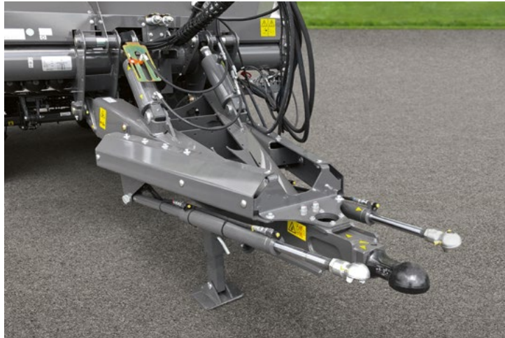
Mechanisch-hydraulische Zwangslenkung Tridemfahrzeug
