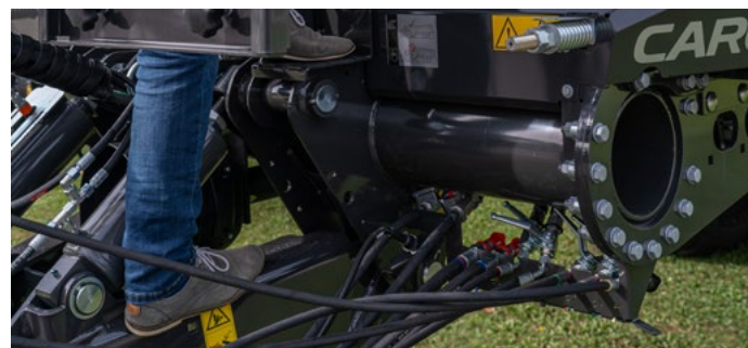
CARGOS 700: Reduzierung der benötigten Steuergeräte durch Kratzbodenfolgeschaltung
