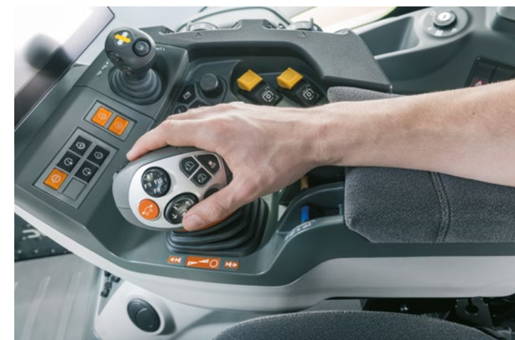
Programmierung der ISOBUS Funktionen auf den Joystick
