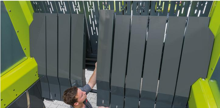
Für die Nutzung ohne Ladeaggregat werden Einlegebleche in die entstandene Lücke eingehängt.
