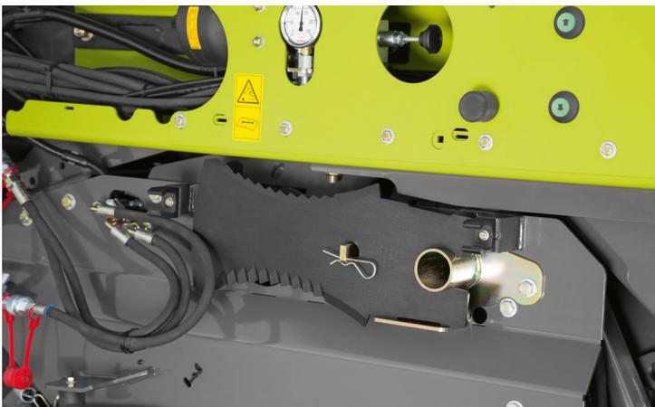
Parkhalterungen ermöglichen das Mitführen von einem zusätzlichen Satz Doppelmesser. So garantieren je vier Seiten optimal geschliffene Schneiden höchste Schnittqualität über lange Einsatzperioden.
