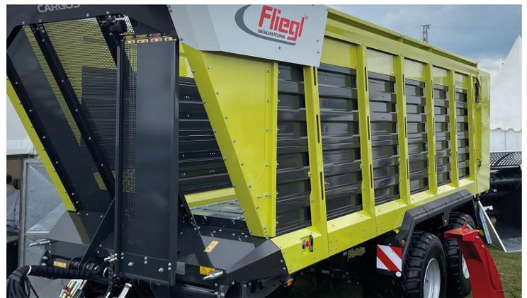
Der CARGOS bietet engen Rungenabstand. Die Einstiegs Luke in der Frontwand gewährleistet ungestörte Kraftverteilung an den Seitenwänden.
