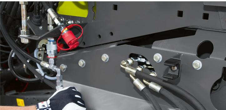
1. Abkuppeln von 5 Hydraulikleitungen und 1 Elektro-Stecker
