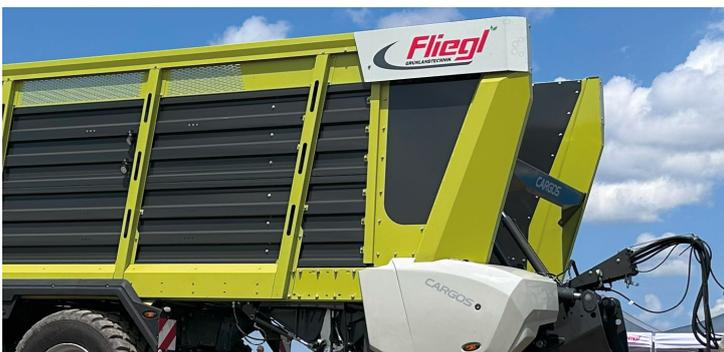
Schwenkbare Frontwand Pro, hydraulisch schwenkbar - für noch mehr Ladevolumen und schnelleres Abladen.
