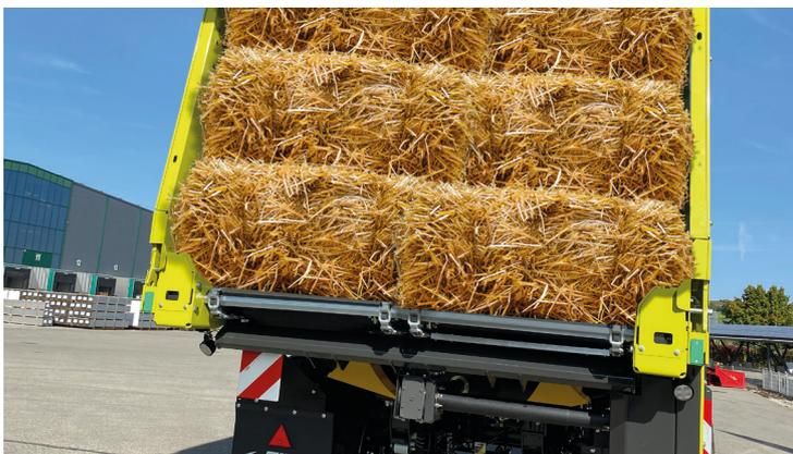
Ballentransport? Dank Rückwärtslauf des Kratzbodens dient der CARGOS auch für den Ballentransport und das ohne zusätzliche Transportsicherung.
