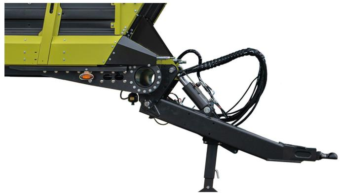
Zugdeichsel CARGOS 700, Stützlast 3 bzw. 4 To
