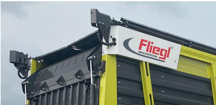
Druckmessung an der Befüllklappe und Drehmomentsensor am Rotor. Diese Kombination beider Sensoren garantiert eine optimale Befüllung des Wagens und die volle Ausnutzung des Ladevolumens.
