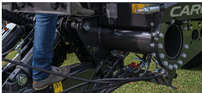
CARGOS 700: Reduzierung der benötigten Steuergeräte durch Kratzbodenfolgeschaltung
