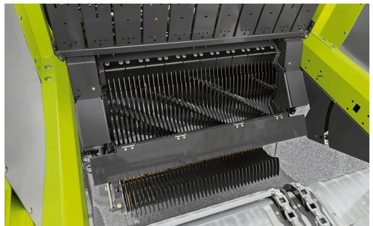
Freier Zugang zum Rotor, Schneidmulde, Messerbalken und Messer. Pluspunkte für die schnelle und effiziente Reinigung der Maschine.
