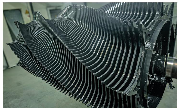
Neunreihig auf den Rotormantel gesteckte und verschweißte Rotorzinken
