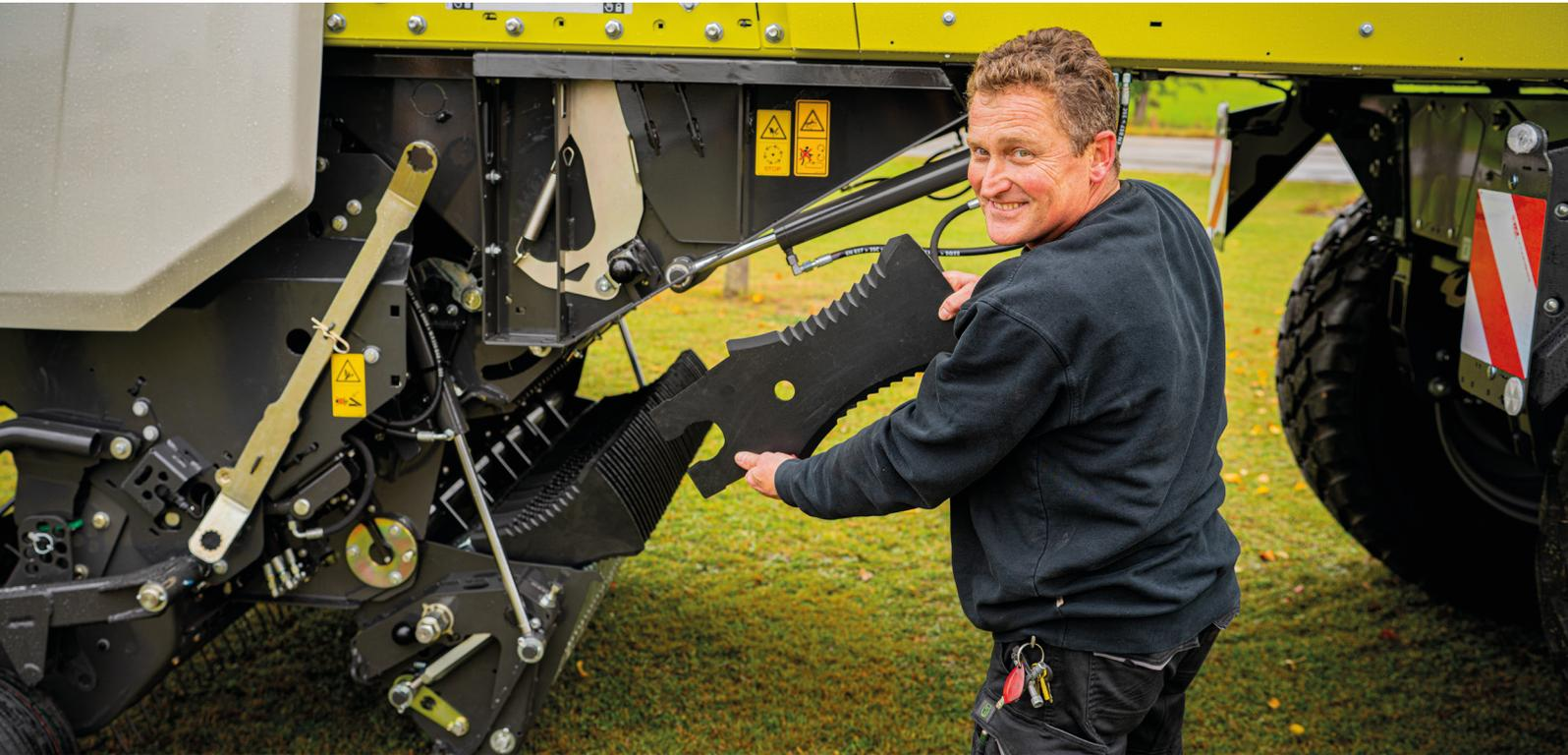
Alle Messer werden zusammen mit dem am Wagen angebrachten Schlüssel entriegelt. So geht das Tauschen oder Drehen der Messer leicht von der Hand. Sollte doch mal ein Messer verkeilt sein, hilft der Schlüssel auch beim leichten Aushebeln einzelner Messer. Dank der hydraulischen Knickdeichsel wird ein aufrechtes Stehen unter dem Wagen ermöglicht.
