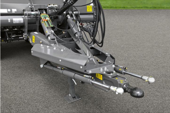
Mechanisch-hydraulische Zwangslenkung Tridemfahrzeug
