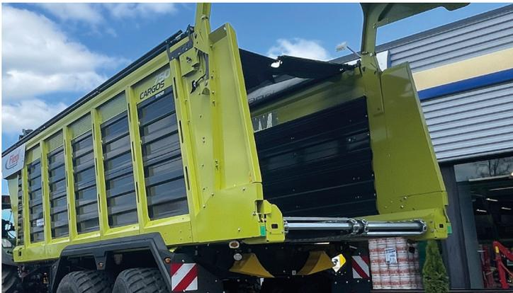
Der Heckdeckel ermöglicht das Laden von 3 x 90er Quaderballen und bietet eine exakt einstellbare Öffnung.
