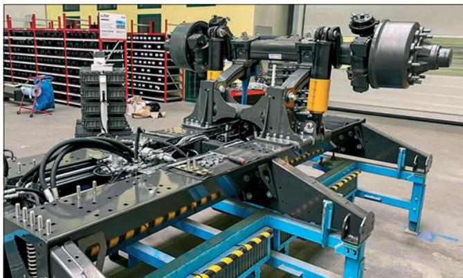
Die Endmontage läuft in vier Takten ab: Takt eins ist die Montage des Achsaggregates.
