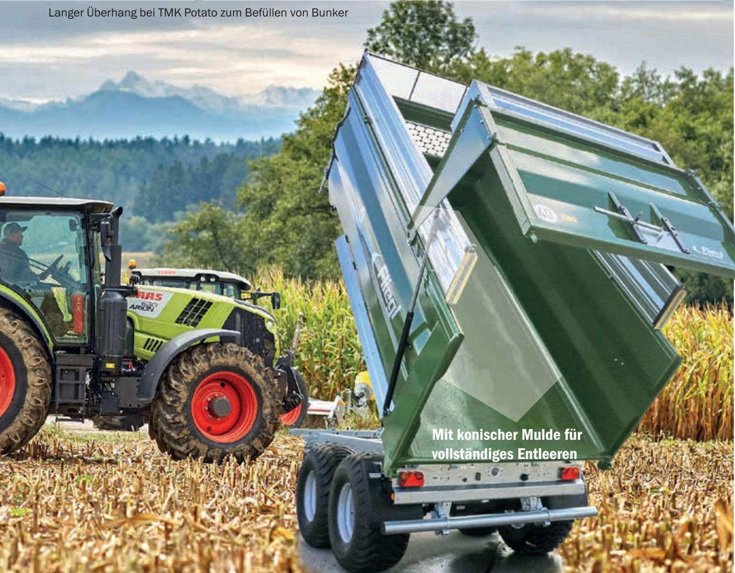
Mit konischer Mulde für vollständiges Entleeren
