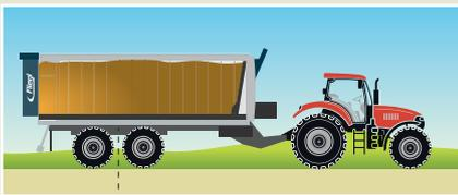
Optimale Anpassung der Stützlast durch mechanische Achsverschiebung (Serie) oder stufenlos hydraulisch (optional) Anpassungsmöglichkeit der Stützlast auch bei Montage von Anbaugeräten (z.B. Streuwerk)
