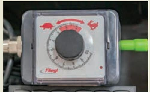
**Elektrisches Potentiometer** mit einstellbarer Vorschubgeschwindigkeit am Bedienpult
