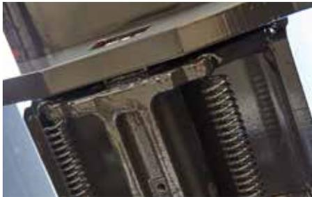
Automatische Hakenverriegelung beim Kippvorgang
