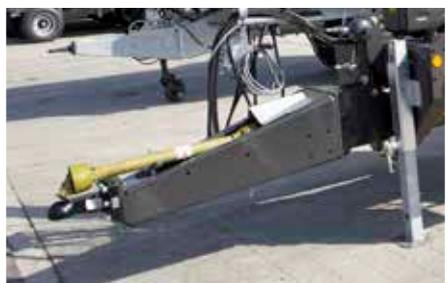
Drehbarer Zugholm für Oben- und Untenanhängung
