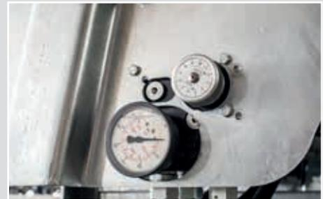
Mechanisches Potentiometer mit einstellbarer Vorschubgeschwindigkeit am Streuwerk
