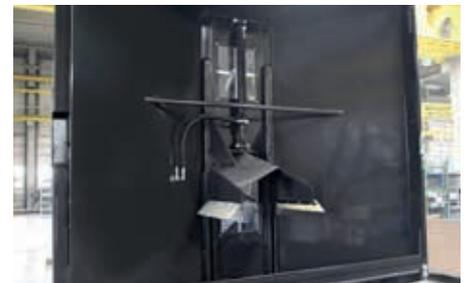
Hydr. Stauschieber ermöglicht im beladenem Zustand das komplette Entleeren der Überladeschnecke
