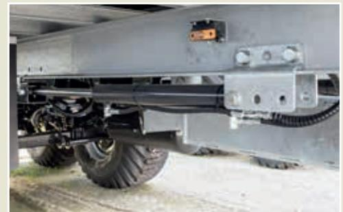
Die stufenlos hydraulische Achsverschiebung
