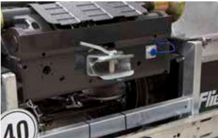
Optional: Bremsanschluß und Hydraulik für 2. Anhänger
