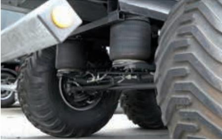
Optional: Luftfederung mit automatischer Kippabsenkung
