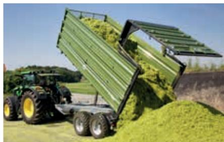
Silierkipper mit hydraulischer Rückwand
