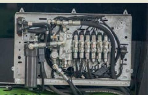
**Steuerblock mit Bedienpult** für besten Bedienungskomfort
