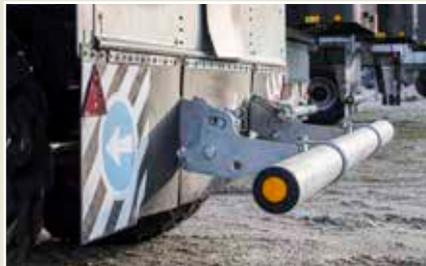
Optional: Unterfahrschutz mechanisch klappbar
