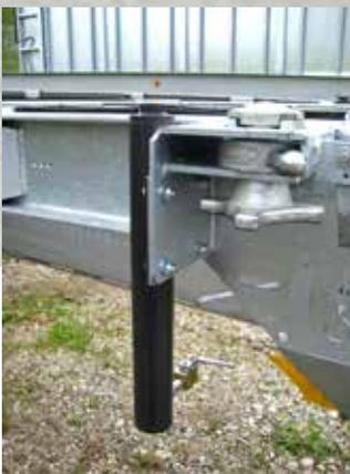
Zylinder für hydraulische Hebeeinrichtung
