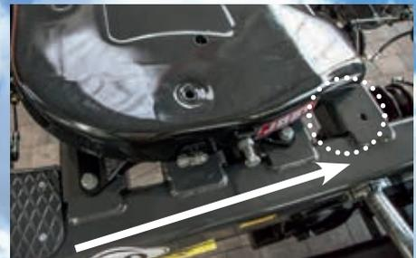
Mechanische Sattelplattenverstellung für Einachs- und Tandem-Dolly
