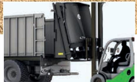
Mit einem Stapler sind alle Streuwerke innerhalb von ca. 20 Minuten einfach montiert.
