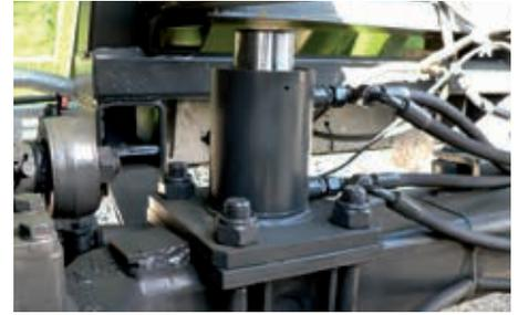
Optional: Hydraulische Abstützung auf die Achse
