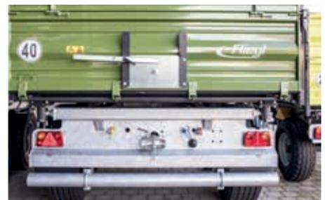
40 km/h Ausführung mit Unterfahrerschutz
