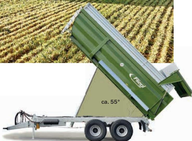
Der Tandem TMK 269 Profi mit einer Muldenlänge von 6,90 m und einem Kippwinkel von ca. 55°
