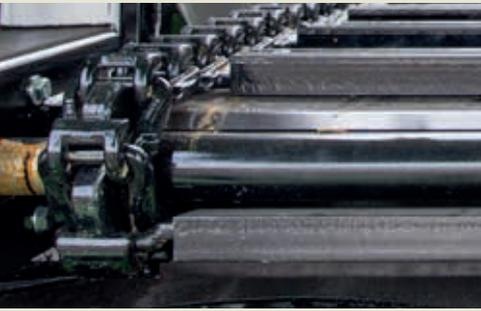
**Geschmiedete Kettenglieder Ø 20 mm** mit einer Bruchlast von 50t sowie massiv ausgelegte oben geschlossene Bandleisten sorgen mit einem Abstand von je 400 mm für einen gleichmäßigen und verlässlichen Materialtransport auch bei extrem schweren Materialien.
