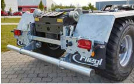
Optional: Ausziehbarer Beleuchtungsträger
