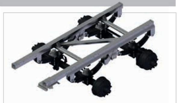
Tandemaggregat Gigant – Parabelfederung
