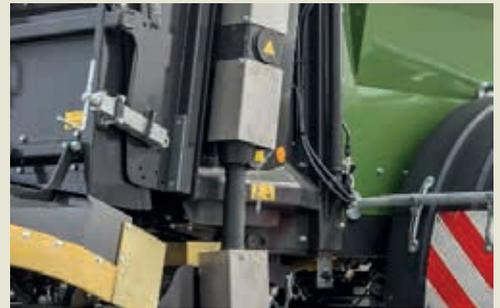
**Fräsrollenantrieb über Gelenkwelle**
