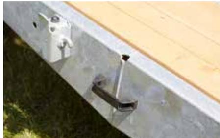
Auffahrrampen mit Holz belegt, Brückenboden aus Stahlblech 3,5 mm lackiert beim TPA 120
