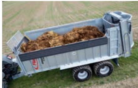
Einfacheres Beladen durch mechanische Seitenwandabklappung - optional links oder rechts
