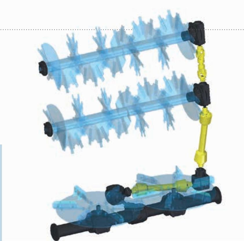
Antriebsstrang der horizontal liegenden Walzen. Überlastsicherung über Nockenschaltkupplung in Gelenkwellen zum Schlepper und Scherschraube in der Gelenkwelle nach dem Winkelgetriebe. Freilaufkupplung zwischen T-Getriebe und Streutellerantrieb
