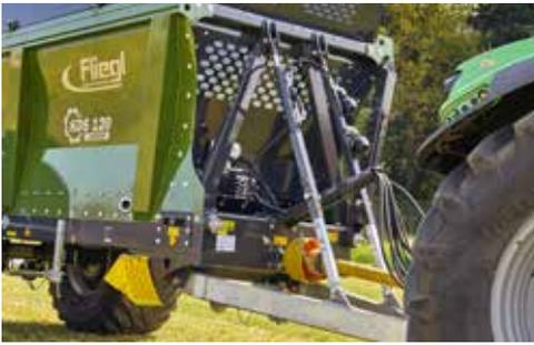
**Hydraulisch gefederte Zugdeichsel.**
