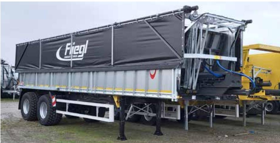
TOPLIFT: Innerhalb kürzester Zeit können die beiden Planenhälften geöffnet und geschlossen werden
