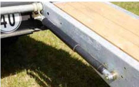
Auffahrrampen serienmäßig mit Federheber und optional auch hydraulisch erhältlich
