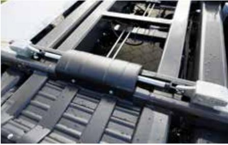
Umsteckbares Verriegelungssystem für Innen- und Aussenverriegelung
