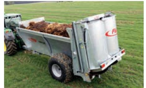
Durch die bewährte Fliegl Abschiebetechnik wird das Material gleichmäßig dem Streuwerk zugeführt. Nach dem Streuen ist der Laderaum nahezu sauber, der Unterboden bleibt im Gegensatz zum herkömmlichen Kratzboden sauber.
