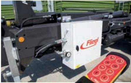
Steuerung mit Funkfernbedienung (optional)
